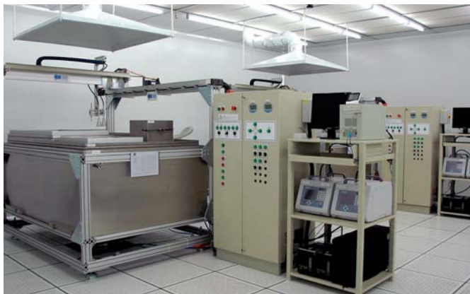
Los procedimientos de prueba de AAF para toda eficiencia incluyen contadores de partículas laser con líquido o sólido en aerosol. Pequeñas fugas pueden ser detectados usando los scanner estáticos y automáticos, propiedad de AAF.
